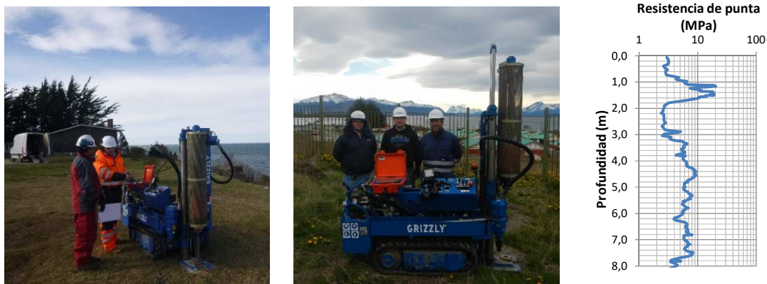
Fig. 1 – Equipo Grizzly (izq.), computadora incorporada (centro) y perfil de resistencia q_d (der.)
